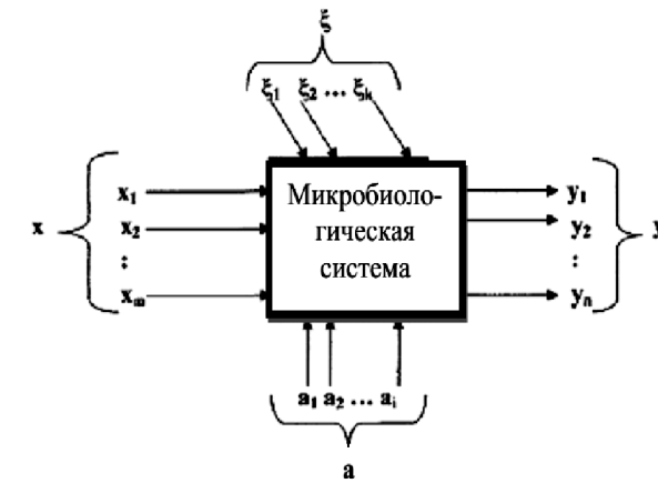
Рис. 6. Структурная схема микробиологической системы
