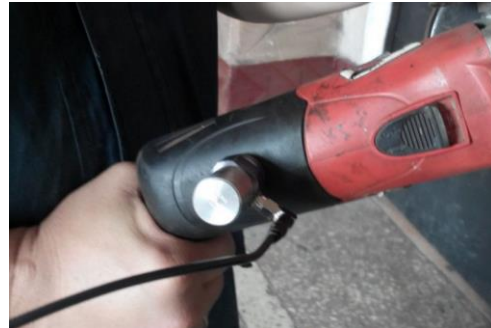
Рис 7. Вимірювання локальної вібрації КШМ
