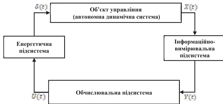
Рис. 2. Структура бортового інформаційно-керуючого комплексу
