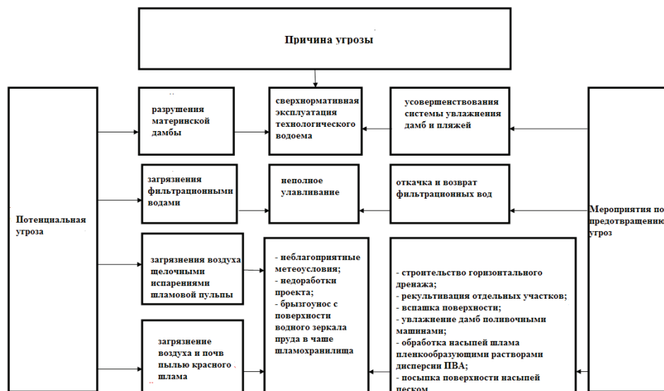
Рис. 3. Потенциальные угрозы во время эксплуатации шламохранилищ НГЗ и меры их предотвращения
