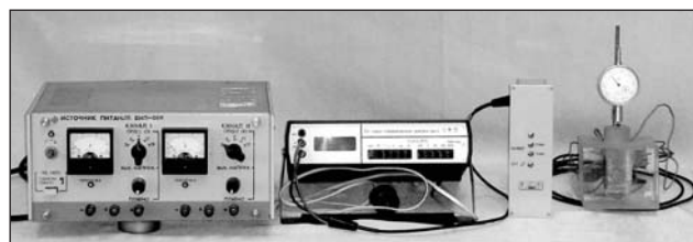
Рис. 1. Стенд для проведення досліджень щодо оптимізації складу коміркової суміші, що твердіє
