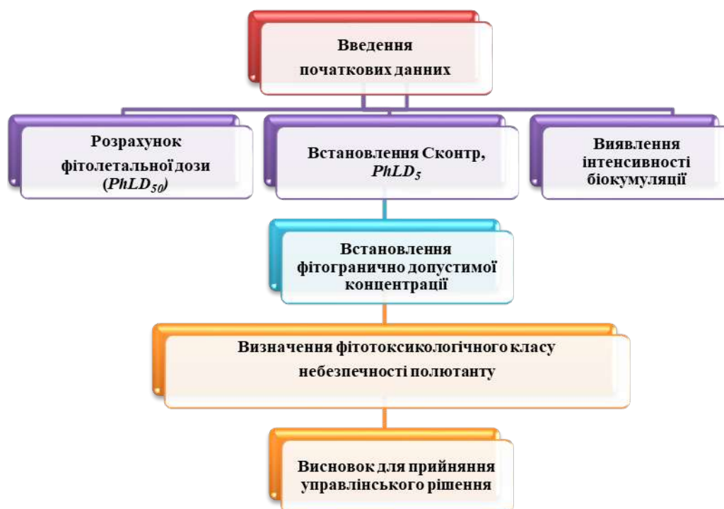
Рис. 8. Блок-схема алгоритму визначення фітотоксикологічного класу та оцінки небезпечності металів
