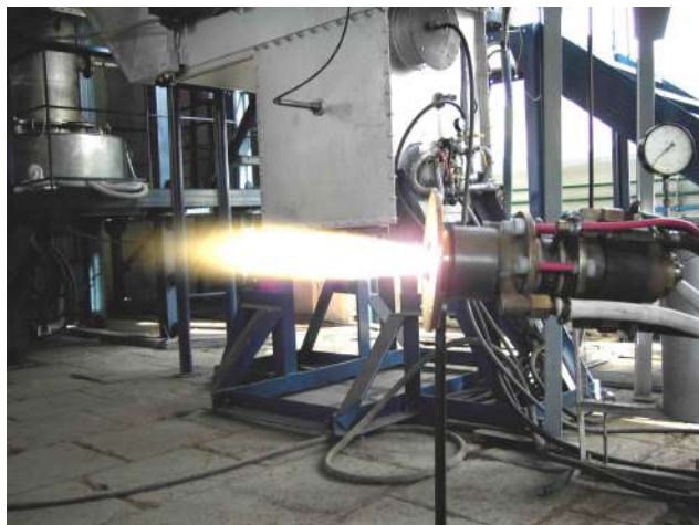
Рис. 2. Пароводяний плазмотрон потужністю 160 кВт у режимі налаштування
