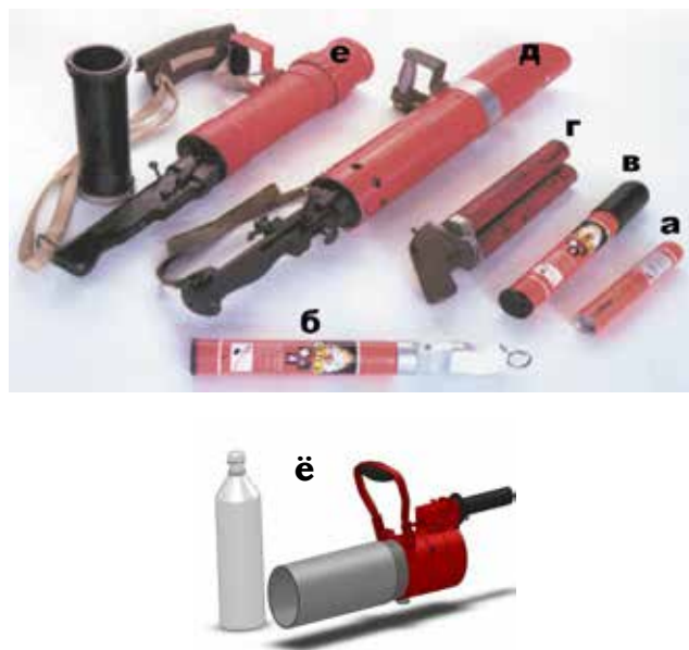
Рис. 2. Импульсные огнетушители, распыляющие выстрелом: а – карманный мОРВ ёмкостью 0,15 л и радиусом тушения до 2 м; б, в – автомобильные мОРВ ёмкостью 0,33 л и радиусом тушения до 4 м: б – с черной ручкой-многозарядный-перезаряжаемый фирмой-изготовителем; и в – со светлой ручкой перезаряжаемый оператором в процессе тушения путём смены контейнеров (тяжёлых); г – трёхствольный со стволами ёмкостью 0,33 л каждый; д – профессиональный пОРВ ёмкостью 2 л и радиусом тушения 6–17 м – с косым срезом ствола, заряжаемого грунтом, песком, грязью, пылью, водой, снегом; е – профессиональный пОРВк контейнерного заряжения, тяжёлый, многозарядный, цилиндрический, металлический контейнер ёмкостью 1 л, со сменными мембранами; ё – профессиональный пОРВк контейнерного заряжения, лёгкий, одноразовый, пластиковый, бутылочный контейнер ёмкостью 0,75 л
