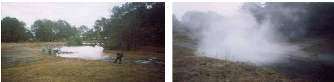
Рис. 4. Остановка группы террористов 10 человек на открытой площади с дистанции 15 м одним выстрелом-распылением 2 кг огнетушащего порошка
