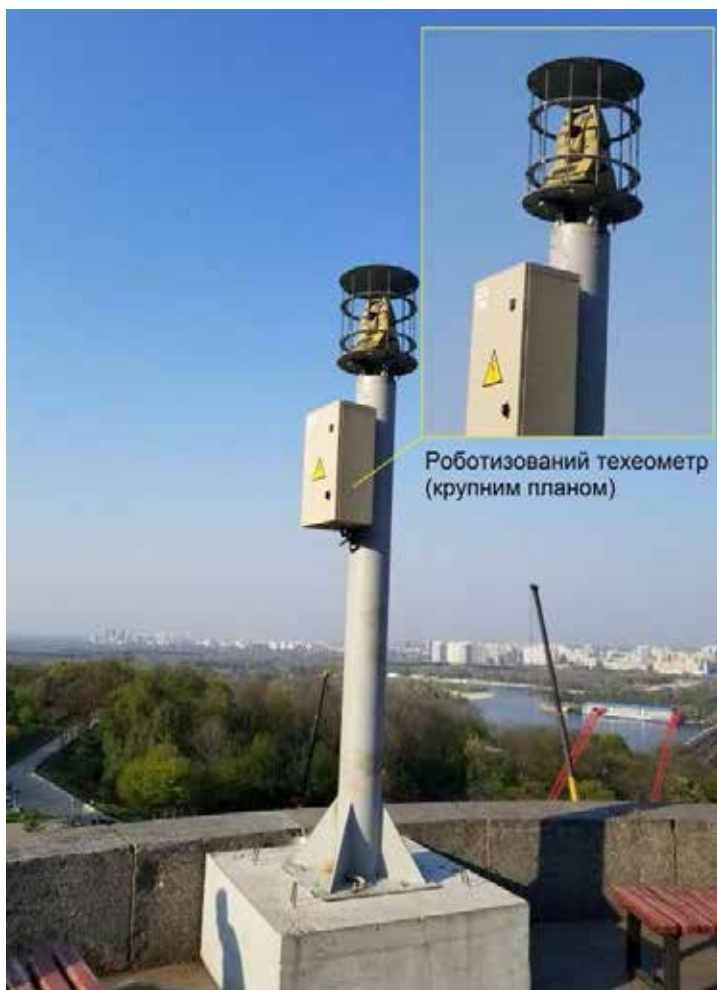
Рис. 1. Статичний пункт роботизованої тахеометрії «Парк Слави», м. Київ
