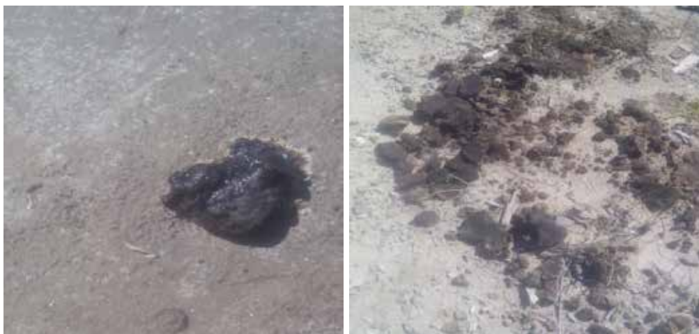
Рис. 4. Просочування нафти та озокериту на поверхню відвальних ґрунтів озокеритової шахти м. Борислава
