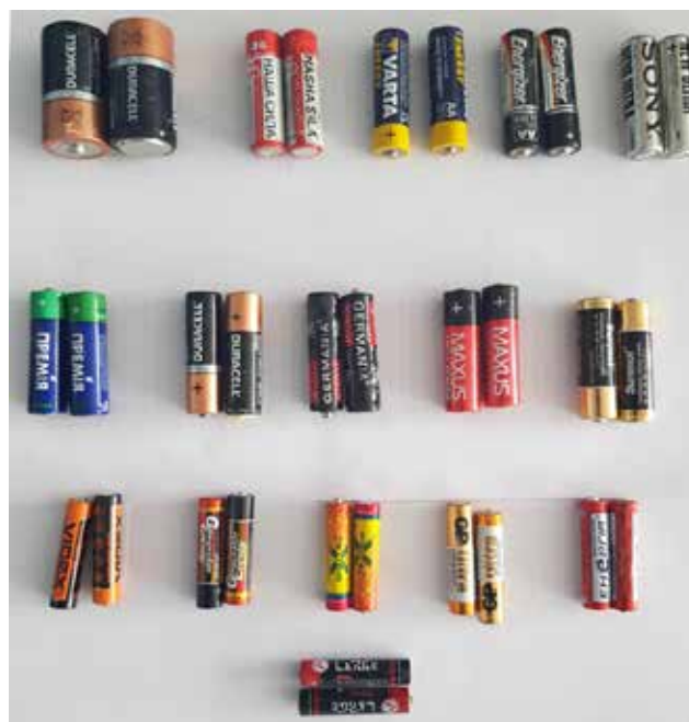
Рис. 2. Набір сольових батарейок та акумуляторів для мікроелементного аналізу
