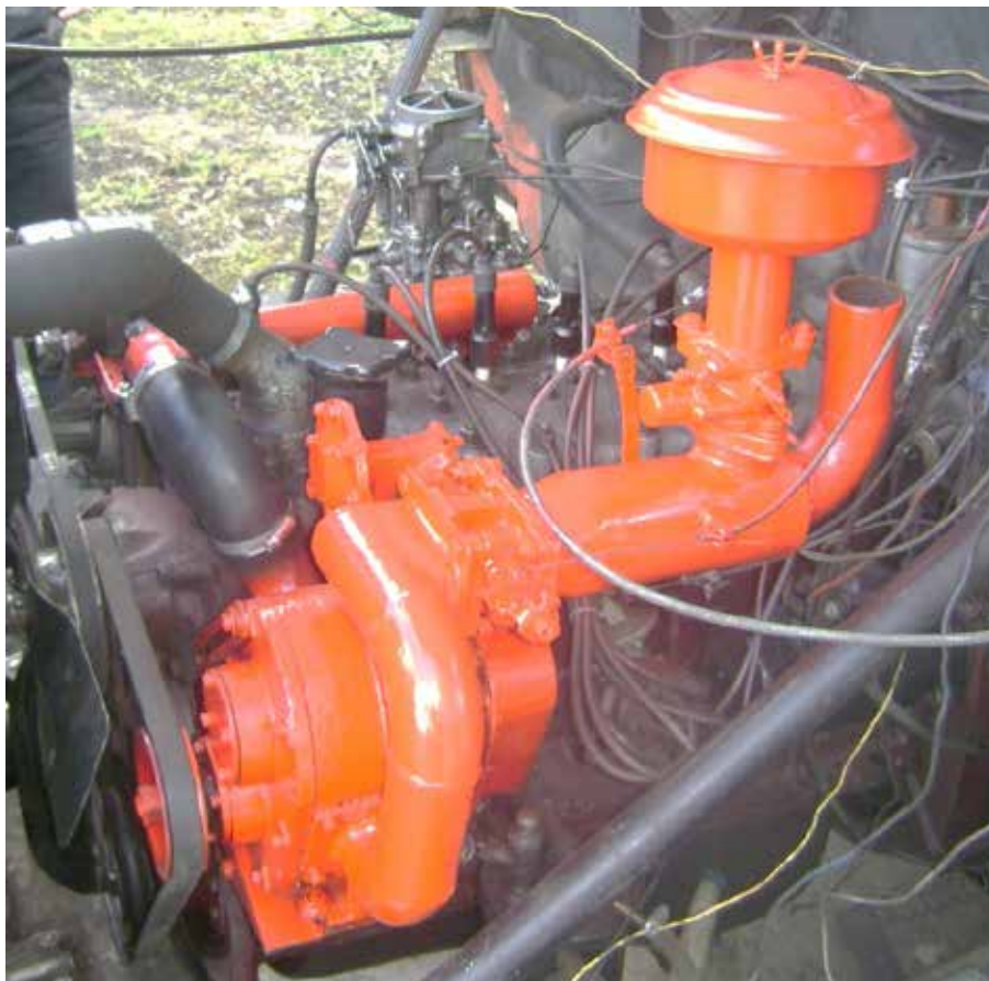
Рис. 2. Загальний вигляд нагнітача (з механічним приводом) газоповітряної суміші в циліндри двигуна газогенераторного автомобіля
