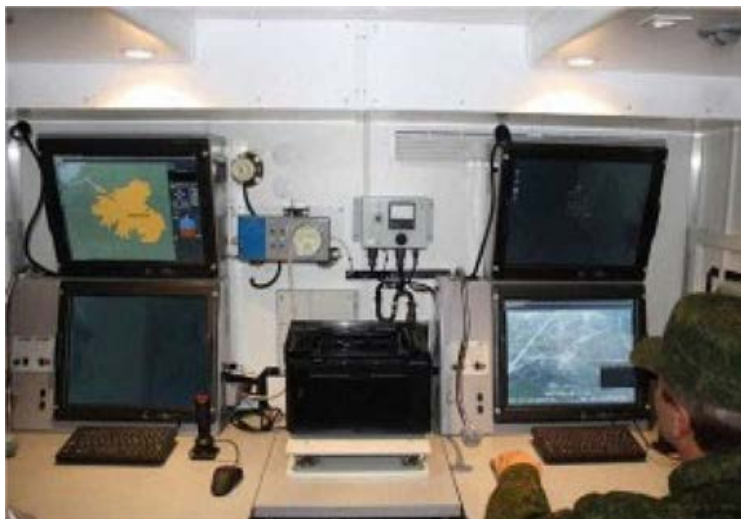
Рис. 1. Формування інтерфейсу оператора із застосуванням багатофункціональних індикаторів
