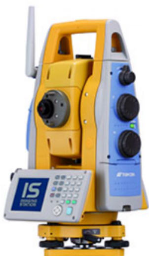
Рис. 5. Фототахеометр Topcon, модифікації військового призначення: IS-305 / IS-303 / IS-301
