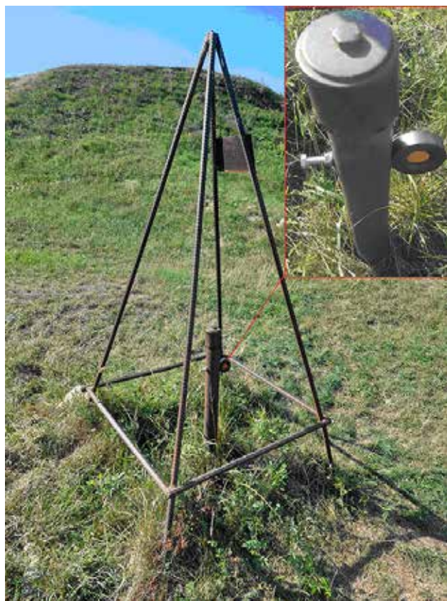
Рис. 3. Модернізований фундаментальний висотний репер Державної геодезичної мережі України із лазерним відбивачем (м. Хотин, Чернівецька область), світлина автора, серпень 2022 р.
