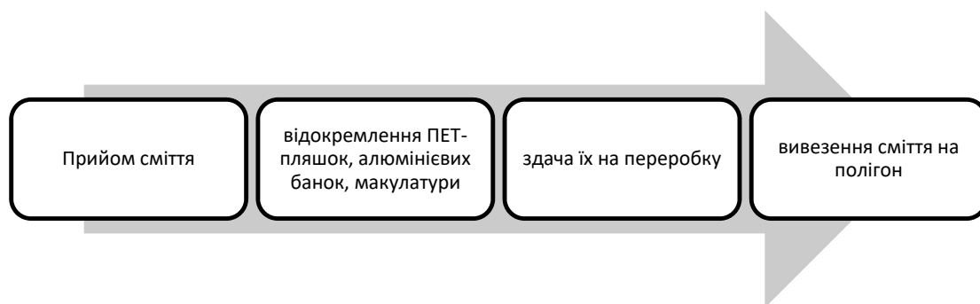
Рис. 5. Етапи роботи сміттесортувальної станції
