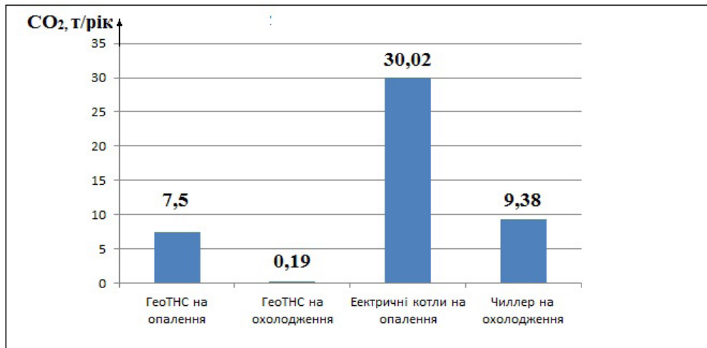
Рис. 6. Прогнозні показники викидів CO 2 за різних технологій опалення та охолодження адміністративної будівлі площею 500 м 2 (Потреба в опаленні на рік 72 000 кВт•год, потреба в охолодженні 45 000 кВт•год)
