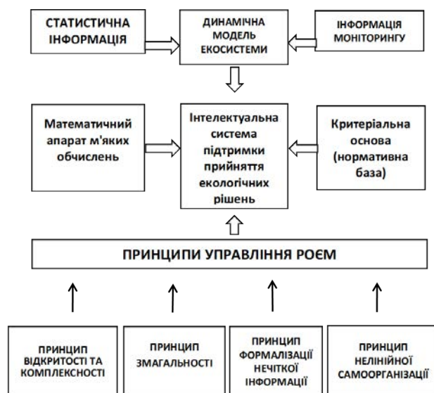
Рис. 2. Принципи організації системи управління керування «роєм» безпілотних апаратів на основі технології інтелектуальних систем
