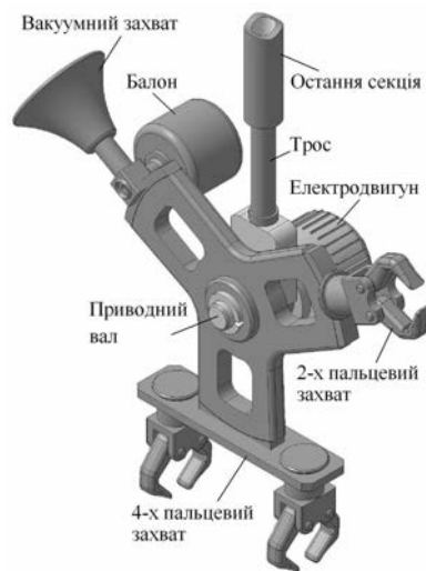
Рис. 4. Револьверна головка із захватами для сміття (див. фрагмент «В» на рис. 3)
