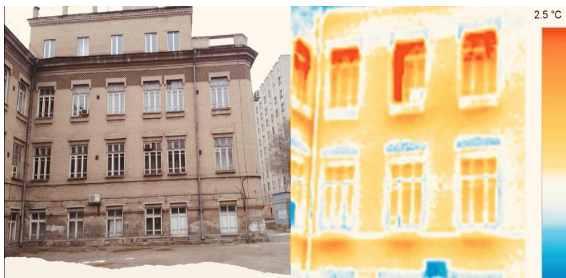
Рис. 3. Тепловізійне обстеження навчального корпусу № 1
