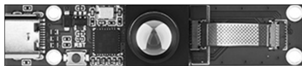
Рис. 3. Тепловізійна камера Waveshare Thermal Imaging 80x62 USB Camera
