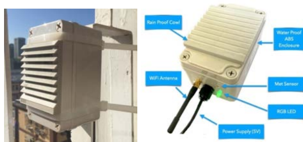
Рис. 3. Загальний вигляд бюджетної автоматичної станції GAIA A12
