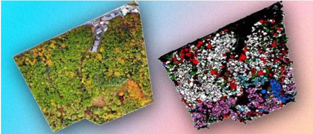
Рис. 4. Приклад поєднання зйомки лісового масиву за допомогою дрону та подальшої обробки неймережею для отримання цифрової моделі [14]
