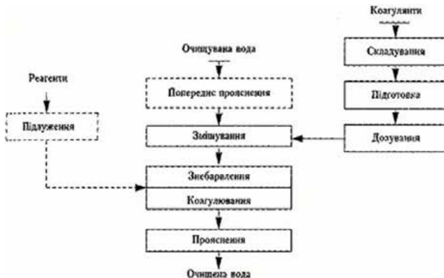
Рис. 2. Схема технологічного процесу очищення стічної води коагулянтами [4]
