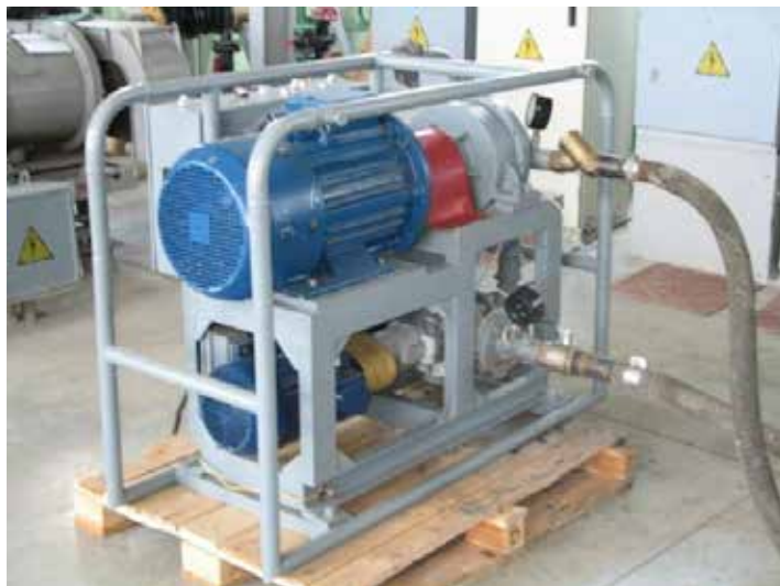
Рис. 3. Гідродинамічний кавітаційний реактор КР-300 [17]
