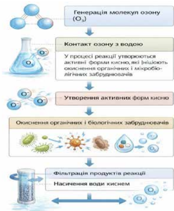
Рис. 3. Схема знезараження води озonom
