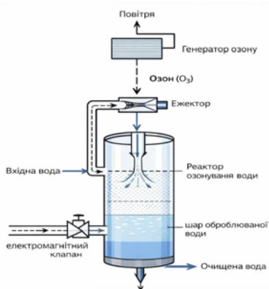
Рис. 4. Принципова схема очищення води озonom за допомогою озонаторної установки
