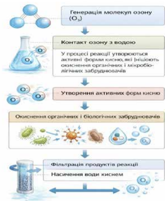
Рис. 3. Схема знезараження води озonom
